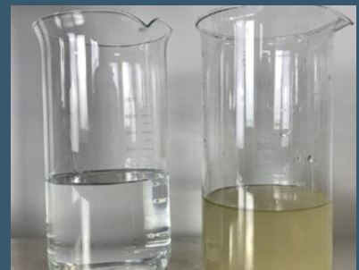
Flusswasser nach Sandfilterdurchgang Links: mit Einsatz von Flockungsmittel Rechts: ohne Einsatz von Flockungsmittel
