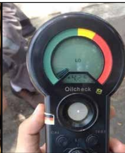
Von links nach rechts: erster Öltest nach 250 h, zweiter Öltest nach 500 h und dritter Öltest nach 1.000 h. Kein Ölwechsel nötig!
