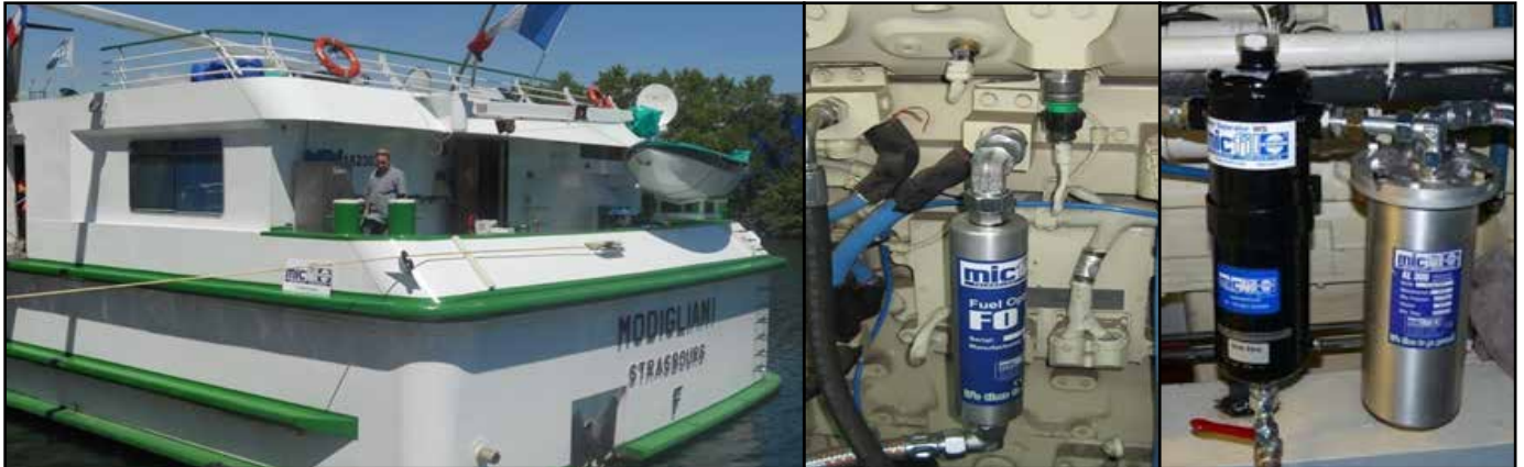
Wechsel des Filtereinsatzes bei Diesel nach 800-1.500 h. Wechsel des Filtereinsatzes für Öl nach 800 h.
