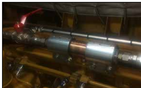
Installation des micfil RENTAR Treibstoffoptimierer am Hauptmotor.
