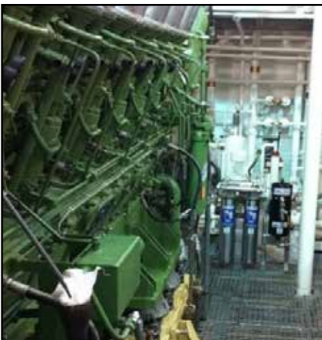
Reinigung des Treibstoffs eines ABC Motors zwischen Tagestank und Hauptmotor. Die max. Durchflussrate beträgt 5.600 l/h.
